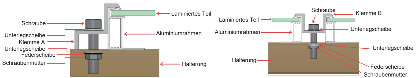
Abbildung 5 Klemminstallation des Monofacial-Moduls
